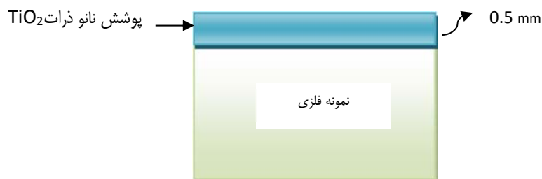
شکل (۱): ضخامت لایه نانوذرات دی اکسید تیتانیوم پوشش داده شده روی نمونه فلزی تهیه شده
