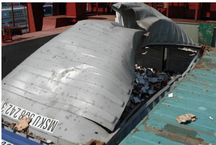
تصویر (۴): ترکیدن کانتینر محتوی فسفید آلومینیوم در اثر حریق در انبار کشتی Maersk Kinloss
