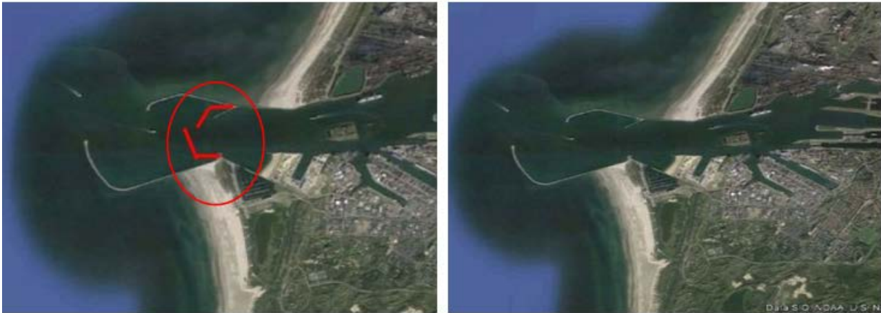
شکل (۱۰): نحوه جانمایی بازوهای موج‌شکن در شهر Velsbroek کشور هلند
